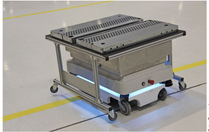
Mobile Industrieroboter übernehmen die Teilelieferung zwischen einzelnen Arbeitsstationen.
